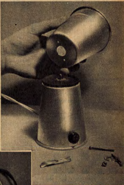
A második alumínium-pohár ráillesztése a tengelytoldalékra
